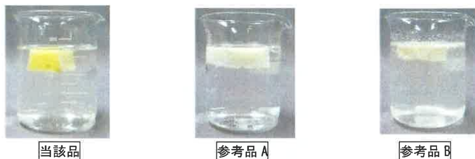
写真3. テスト5分後の様子（回転数200±10rpmで攪拌）
